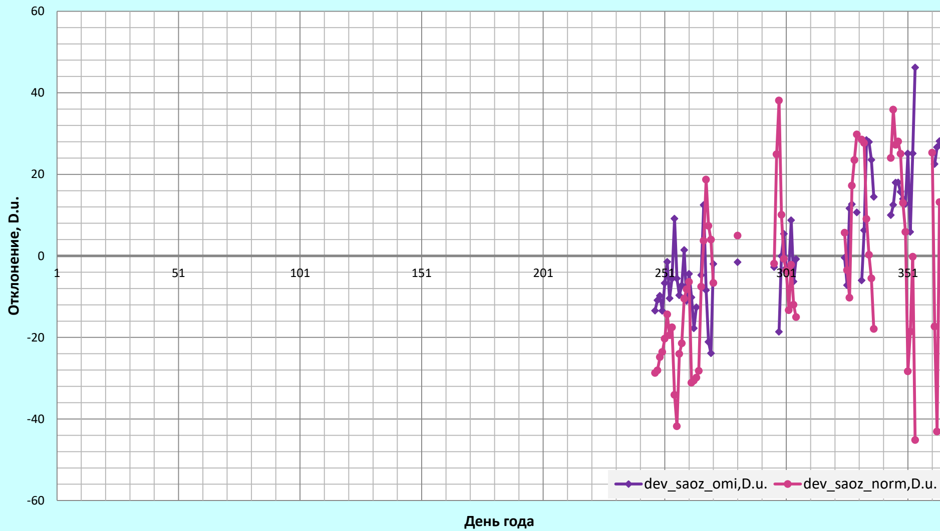
Абсолютные отклонения (D.u.) данных наземных измерений CO 2 (Mini-SAOZ) от данных спутниковых измерений CO 2 (OMI,NASA) и отклонение наземных измерений (Mini-SAOZ) от климатических норм для ст.Долгопрудный, 1 января - 31 декабря 2018 года.
