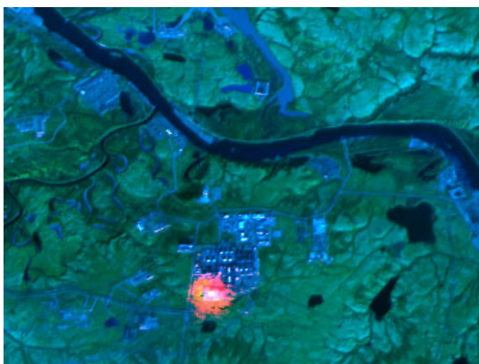
Рисунок 5 Снимок факела («горячей точки») от сжигания попутного нефтяного газа со спутника SPOT 4
