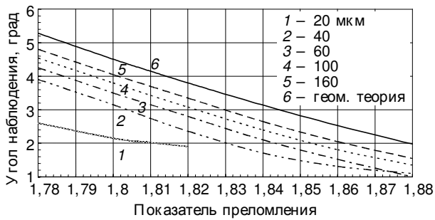
Рис. 6. Зависимость угла радуги \varphi^{(1)} от показателя преломления n , полученная из теории Ми для сфер различных диаметров при \lambda = 0,58 мкм (желтый свет) и для сравнения рассчитанная по геометрической теории
