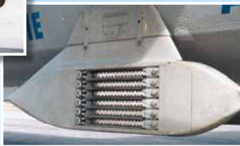
Технические средства для сброса гранул твердой углекислоты, жидкого азота и грубодисперсных порошков Technical aids to release solid carbonic acid, liquid nitrogen and coarse powders
