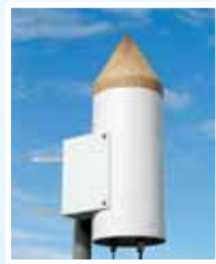
Радиолокационный измеритель осадков «Капля»
