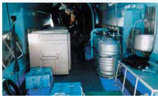
Технические средства для сброса гранул твердой углекислоты, жидкого азота и грубодисперсных порошков Technical aids to release solid carbonic acid, liquid nitrogen and coarse powders
