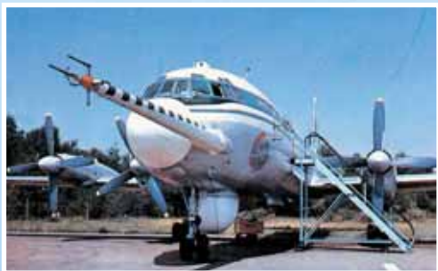
Самолёты-метеолaborатории Ан-26, Ан-30, Ил-18 и их приборные комплексы для исследований облаков и атмосферы Aircraft labs AN-26, AN-30 and IL-18 and their instrumentation to study clouds and atmosphere
