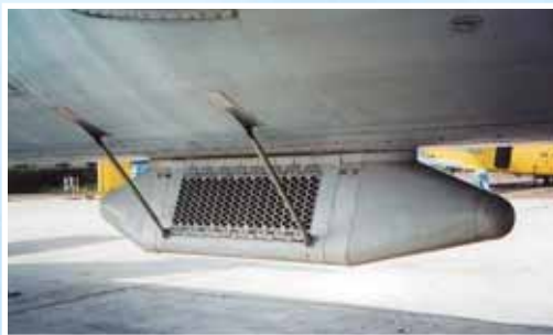
Система отстрела пиропатронов УВ-28 System UV-28 to release pyrotechnic flares
